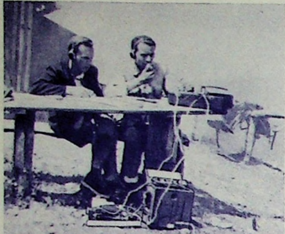
Bild 5. Der 2m-Transceiver während des Betriebes in den Allgäuer Alpen. Im Vordergrund Batterie und Umformer
